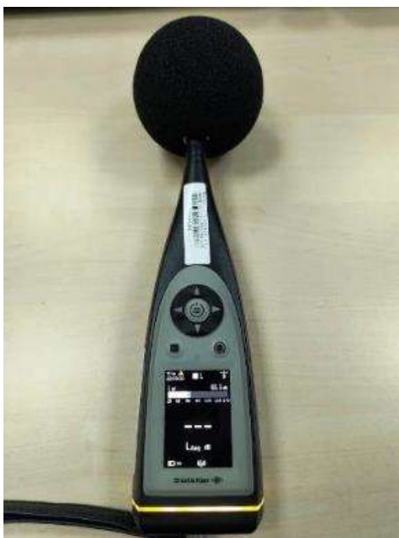
Слика 2: Еталонирани уређај за мерење буке (фонометар) Комуналне милиције Града Београда
